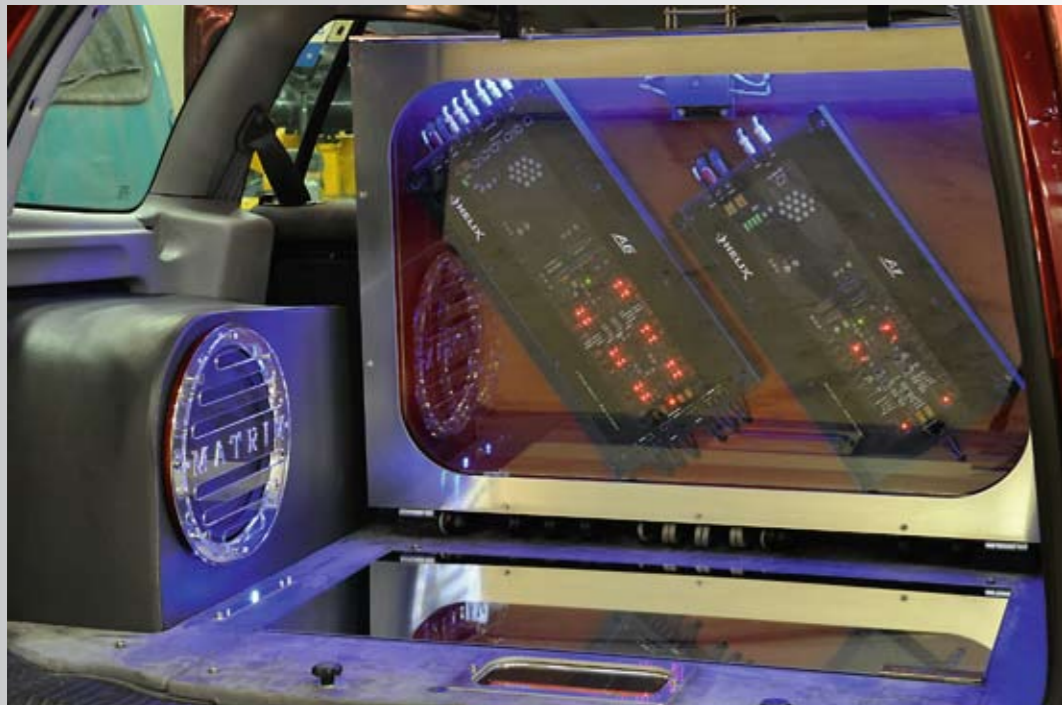
▲ Tavaratilasta löytyy hieno pystyyn nostettava laiteräkki kahdelle Helixin A-sarjan vahvistimelle. Telineen metalliosat leikautettiin tamperelaisessa Il-Met Oy:ssä. Metallikehyksiä lukuun ottamatta lähes kaikki muu onkin sitten tehty itse. Jani ei edes lähde arvioimaan asennuksiin käyttämänsä aikaa, vaan toteaa vain, että kaikki vapaa-aika ja vähän päällekin on käytetty tallilla puuhasteluun. Kymppituumaiselle Matrix-elementille valmistetulla suljetulla kotelolla on kokoa noin 40 litraa. Painoa löytyy myös reippaasti eli lähes 35 kiloa. Tukevuutta antaa paksu, noin 40-millinen kerros betonihartsia. Kuulemma kotelon seinämästä ei enää mennä läpi edes iskuporakoneella...
