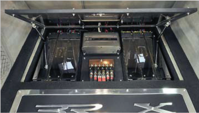
▲ Nice! Kaksi kromattua Braxin high end -päättettä sekä Alpinen F1-signaaliprosu. Myös itse valmistettu sulakeblokki on hieno yksityiskohta. Kansi nousee ja laskee kaasujousien varassa.
